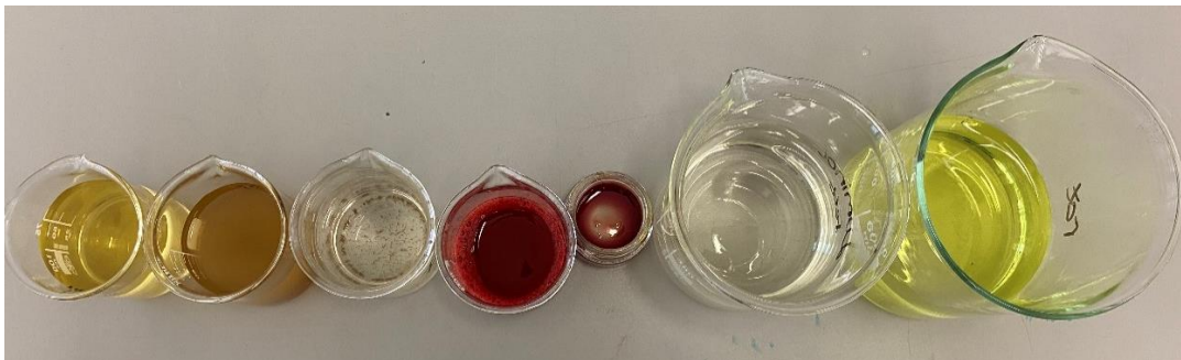
Eisen(III)-chlorid-Lösung, 2x Brunnenwasser, frisches Schweineblut, altes Schweineblut, Luminol-Lösung, Kaliumhexacyanoferrat-Wasserstoffperoxid-Lösung
