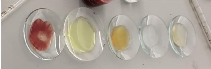
Versuchsaufbau: Schweineblut, Kaliumhexacyanoferrat-Lösung, Eisen(III)-chlorid-Lösung, Brunnenwasser, Wasserstoffperoxid
