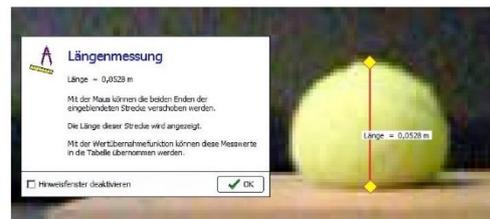
Abb. 5: Messung der Höhe des auftreffenden Tennisballes
