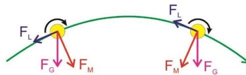
Abb. 8: Kräfte, die auf einen mit Vorwärtsdrall (Topspin) geschlagenen Tennisball wirken
