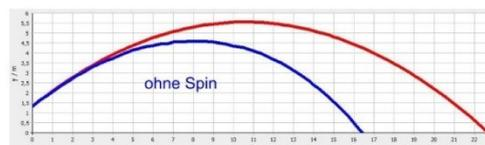
Abb. 12: Ideale Bahnkurve (rot, Berechnung ohne Luftreibung und ohne Magnus-Effekt) und reale Bahnkurve (blau, Messwerte der Videoanalyse) eines Tennisballflugs ohne Spin
